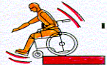
rampa o scala senza parapetto o cordolo
